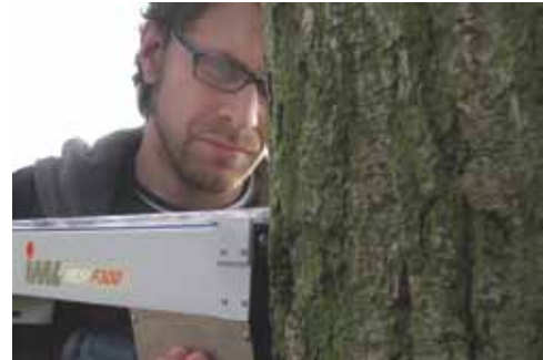
Abb. zeigt IML-RESI F-Serie (F300) am Baum
