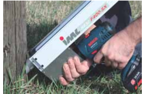
Abb. zeigt IML-RESI F-Serie (F400SX) am Holzmast
