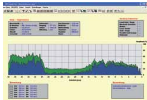
Abb. zeigt Screenshot IML Software Center PD-Tools Pro mit Zusatzmodul FEED (zusätzliche Aufzeichnung der Vorschubkurve)
