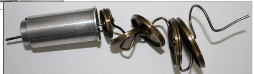
Verbogene Bohrnadel in der Teleskopführung (IML-RESI M300)
